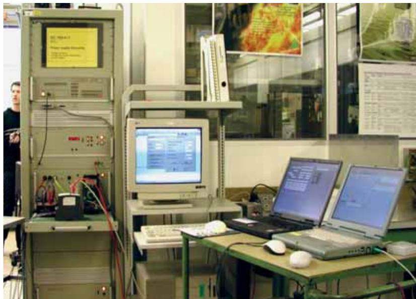
Medición del comportamiento de los aparatos en caso de caídas y oscilaciones de tensión o de interrupciones de corta duración del suministro de energía auxiliar.
