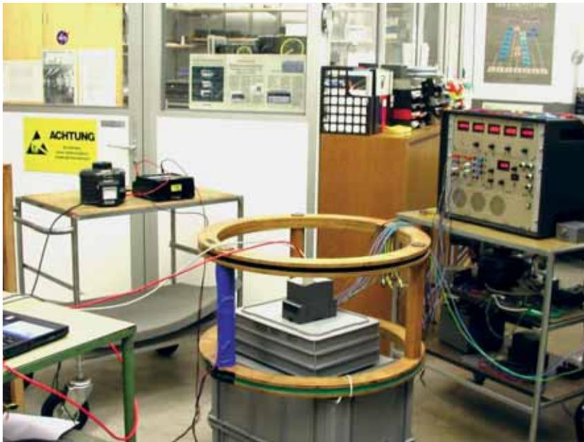
Determinación del comportamiento del aparato bajo la influencia de un campo electromagnético externo creado con una bobina de Helmholtz.
